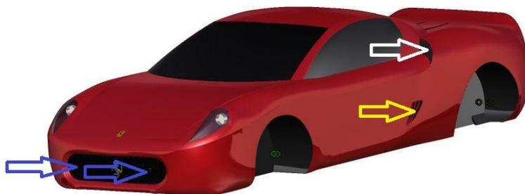
*Figura 2.19:* In blu il flusso di aria diretti ai gruppi radianti anteriori; in bianco i flussi di aria diretti all'airbox e vano motore; in giallo i flussi di aria diretti ai radiatori dell'olio.
