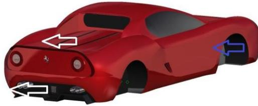
Figura 2.20: Flussi di aria uscenti dal motore (in bianco) e dai radiatori del liquido di raffreddamento (in blu).
